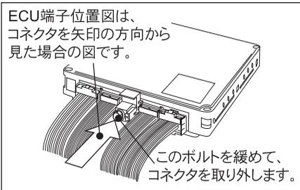
5. ECUに接続されている車両ハーネスのコネクタをECUから取外します。
