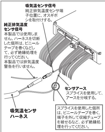
7. ECU端子位置図を参考にして、センサアース位置に 3. で被覆を剥いた吸気温センサハーネスをスプライズを使用して分岐してください。
