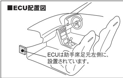
4. ECU配置図を参考にして、ECU配置場所を確認します。
