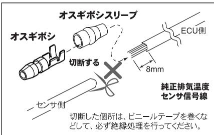
6. ECU端子位置図を参考にして、吸気温センサ信号位置のハーネスを切断し、ECU側のハーネスにオスギボシを取付けます。
