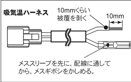
3. 別売の吸気温センサハーネスの末端の片側にメスギボシ・スリーブを取付けます。もう片側は、スプライスで分岐配線を行えるよう被覆を10mmほど剥きます。
