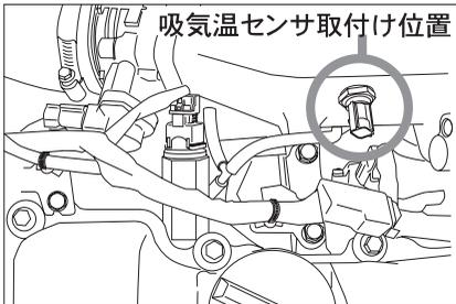
吸気温度センサ取付け位置図
