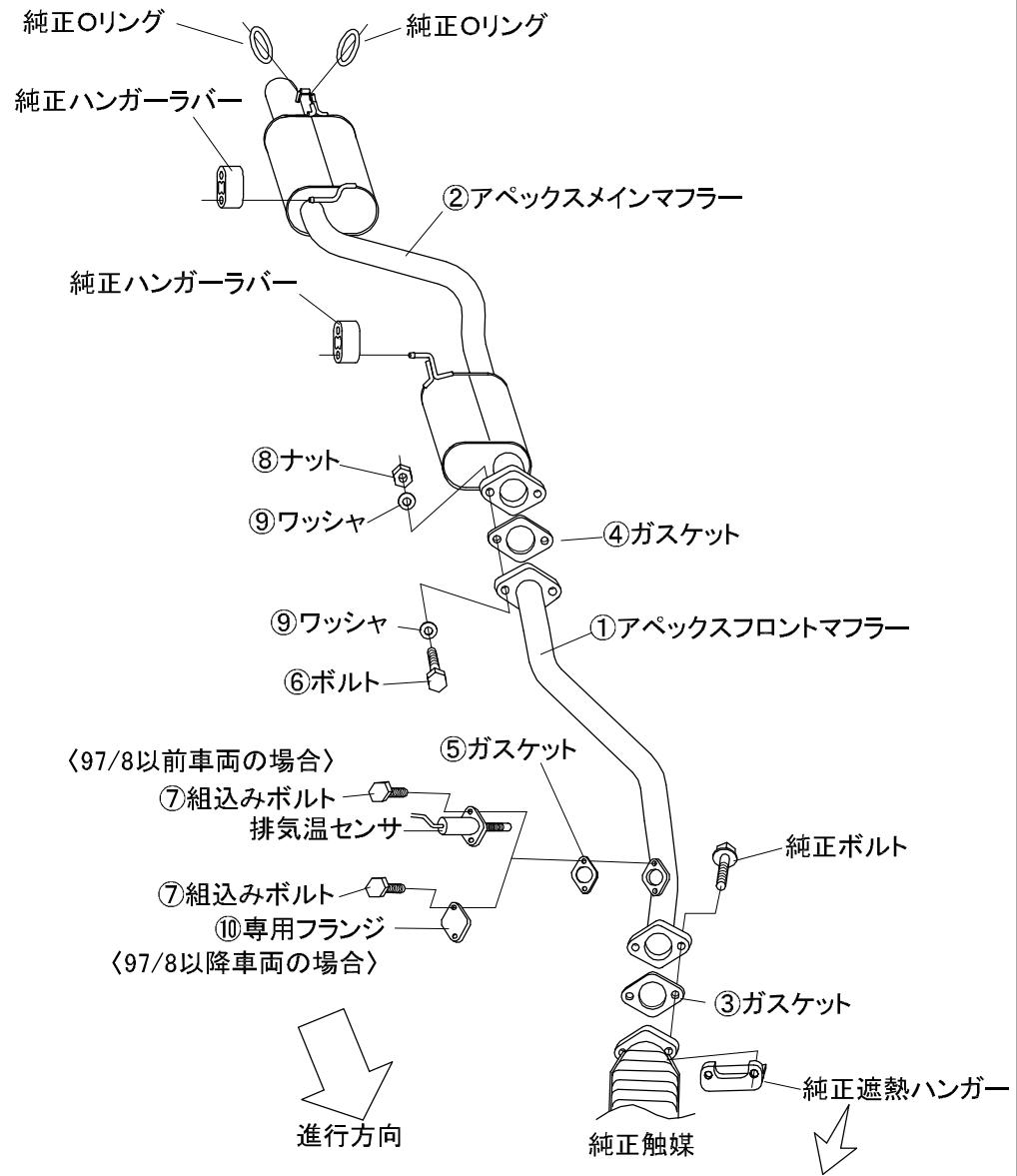
※純正遮熱ハンガーをフランジとのクリアランスが10~15mm確保できるように折り曲げてください。
