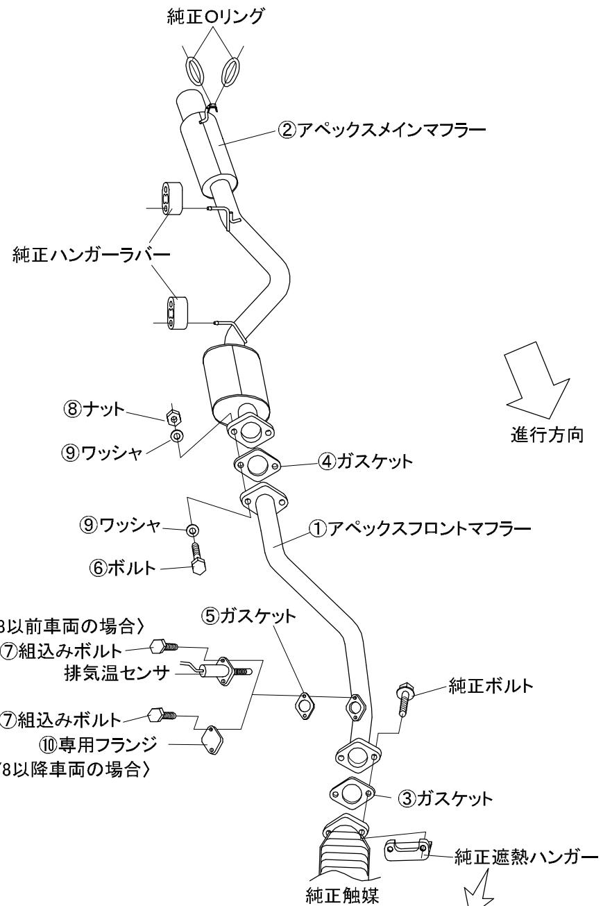
※純正遮熱ハンガーをフランジとのクリアランスが10～15mm確保できるように折り曲げてください。
