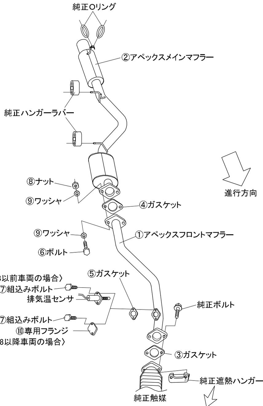
※純正遮熱ハンガーをフランジとのクリアランスが10~15mm確保できるように折り曲げてください。
