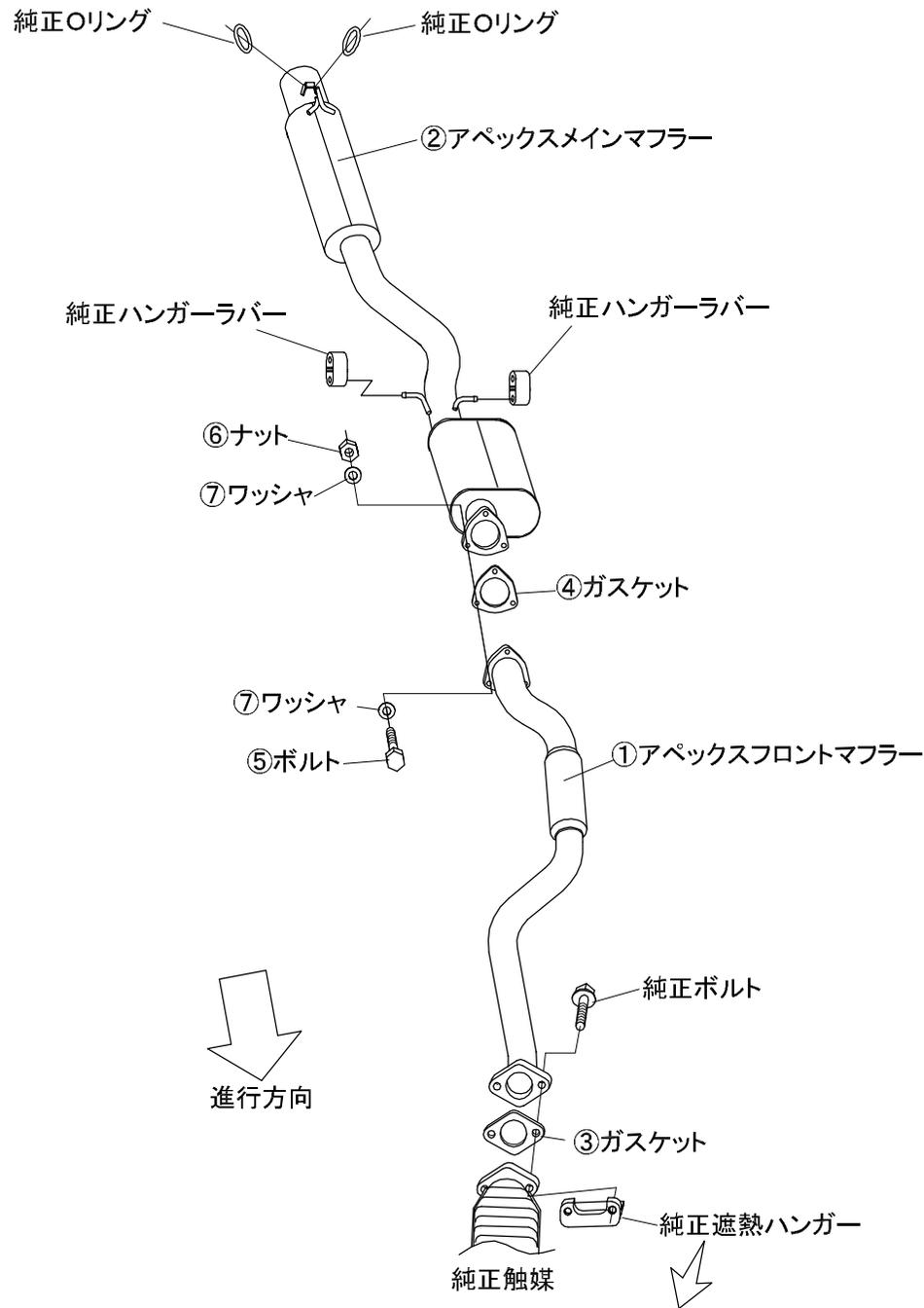
※純正遮熱ハンガーをフランジとのクリアランスが10~15mm確保できるように折り曲げてください。
