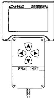
FC コマンダーを POWER-FC と接続して使用することにより、各種データのモニター機能、セッティングデータの変更などが行えるようになります。
